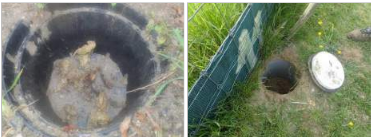
Photos 138 : à gauche, seau de capture enterré ; à droite, exemple d'amélioration d'un seau avec l'existence d'une section de tube PVC munie d'un couvercle pour interrompre les captures, © CEREMA
